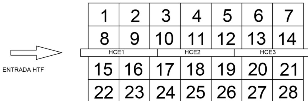
Figura 2.8. Identificación de espejos en el Solar Collector Element (Elemento Colector Solar) SCE
