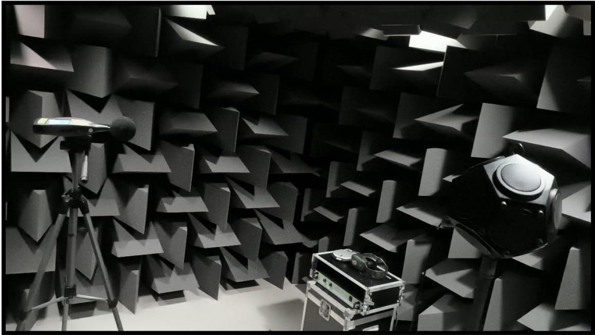
Figura 113: Posición de fuente 1 tercera medida, en el interior de la sala acústica.
