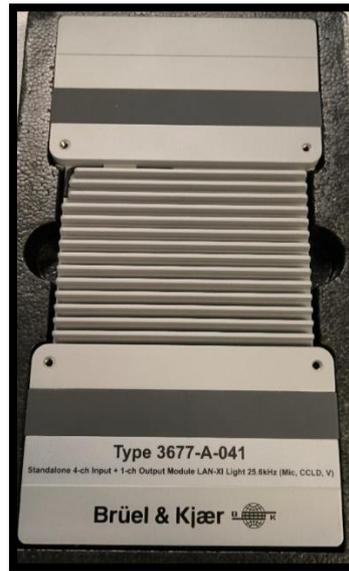
Figura 10: Unidad de adquisición de datos LAN-XI Light Tipo 3677.
