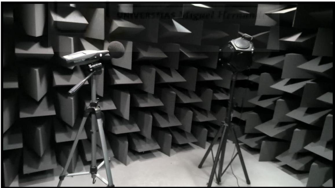
*Figura 116: Posición de fuente 2 primera medida, en el interior de la sala acústica.*
