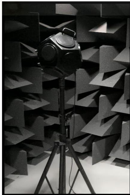
Figura 19: Dodecaedro montado sobre el trípode.
