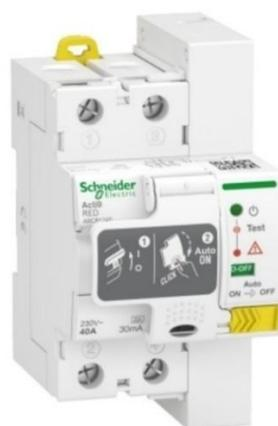
*Ilustración 54: Diferencial auto rearmable Acti9 RED, 2P, 40A, 30 mA, tipo A*
