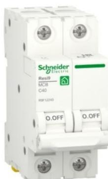
*Ilustración 55: Interruptor Magnetotérmico; Resi9; 2P; 40 A; 6000 A; 230 V*
