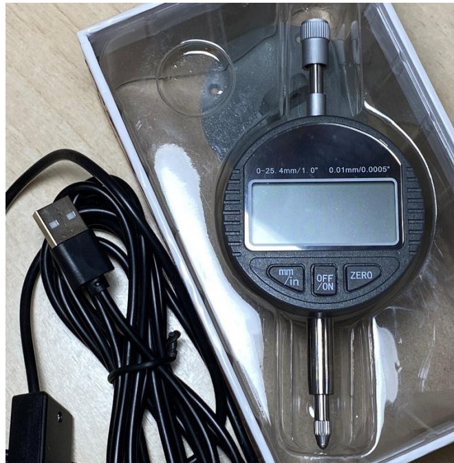
Ilustración 7-12: medidor dial digital. Fuente: elaboración propia
