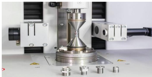
Ilustración 3-3: medición óptica de árboles de levas. Fuente: Mahr
