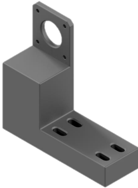
Ilustración 7-10: soporte motor. Fuente: elaboración propia
