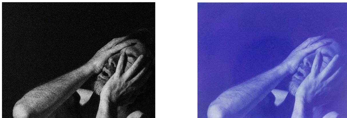
Fig. 31 y 32: Transformación sufrida por el contacto con vinagre. Fotografías autor J. M. Munilla (2025)
