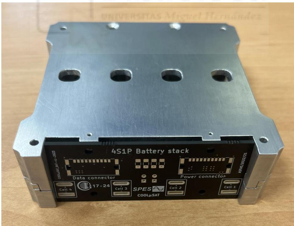
Figura 36. Caja ensamblada con PCB atornillada.
