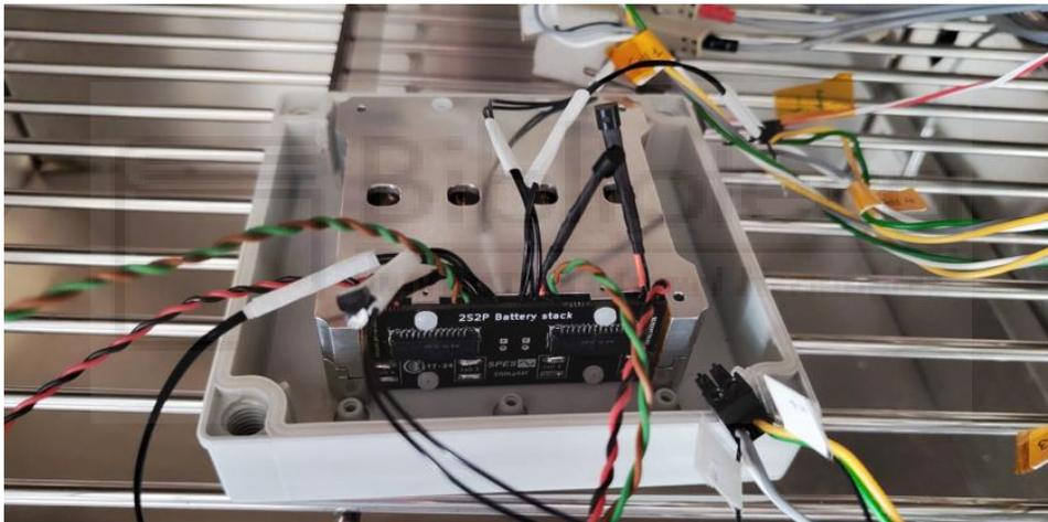
Figura 19. Caja de baterías en la cámara con los sensores.
