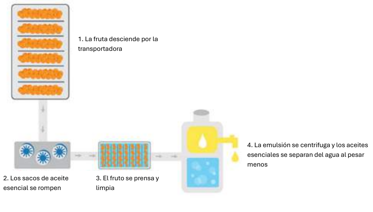
Figura.6: Proceso de extracción por prensado en frío (NDA, 2017).
