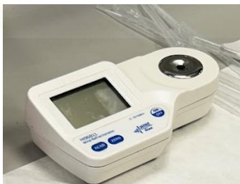
Fotografía 4: Refractómetro empleado para medir los grados °Brix (SST).
