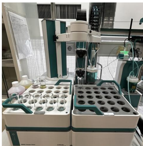
Fotografía 5: Valorador automático Metrohm, utilizado para determinar la acidez.
