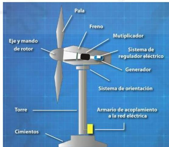
Figura 9. Partes de un aerogenerador.
