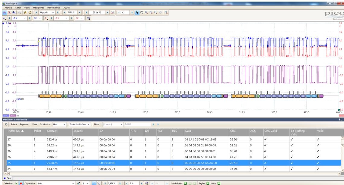
Figura 3.8. Captura del osciloscopio cuando se envía el contenido de la EEPROM
