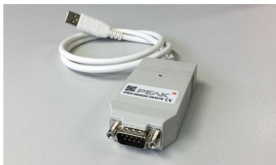
Figura 2.17. Adaptador PCAN USB
