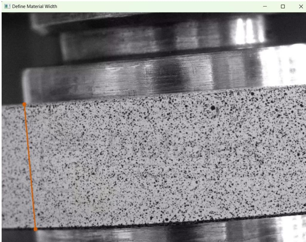
Esto permite conocer la altura de la probeta en píxeles, medida vertical que se usará posteriormente para calcular la escala  $\frac{mm}{pix}$ .
