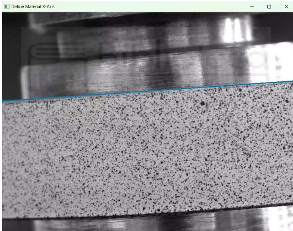
Para ello, el usuario debe hacer clic sobre el extremo superior izquierdo visible de la probeta y posteriormente sobre el extremo superior derecho, como se puede observar en la Figura 4.8.
