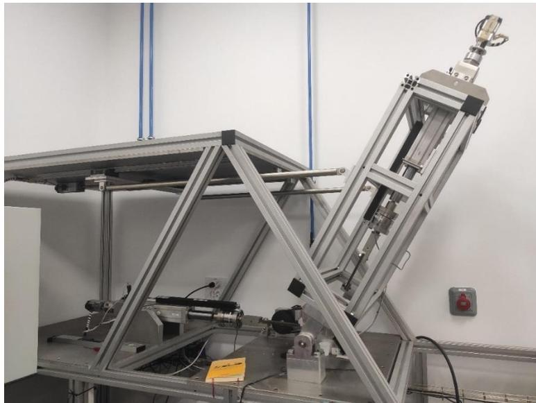
Figura 4.1. Vista general del banco de ensayos de tracción con ángulo variable
