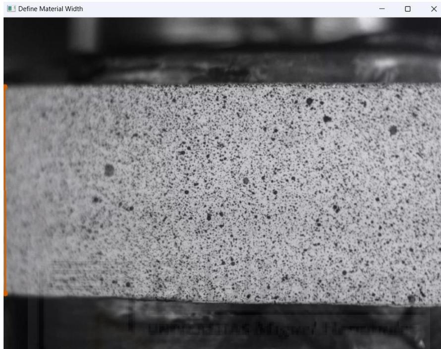
Figura 4.12. Definición del ancho de probeta con mala visibilidad del extremo izquierdo del pin en TRIP-18 (línea naranja).
