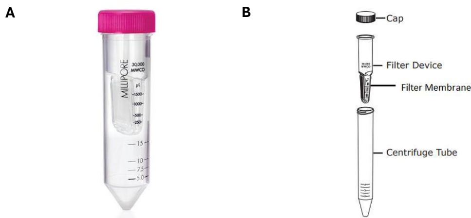
Figura 10. A: tubo Amicon Ultra-15 con un volumen de 15 mL. B: esquema explicativo de las partes que componen el tubo Amicon Ultra-15, que son el tapón, el dispositivo filtrante que contiene la membrana y el tubo de centrifuga.
