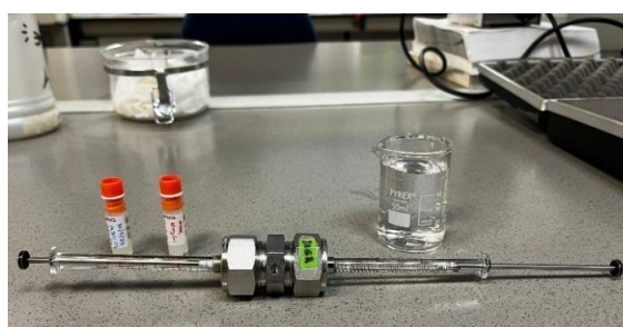
Figura 15. Extrusor (Liposofast) montado para la preparación de liposomas. El dispositivo incluye un soporte central que aloja una membrana de policarbonato con poros de tamaño definido (por ejemplo, 100 nm), utilizada para homogeneizar el tamaño de los liposomas mediante extrusión. En
