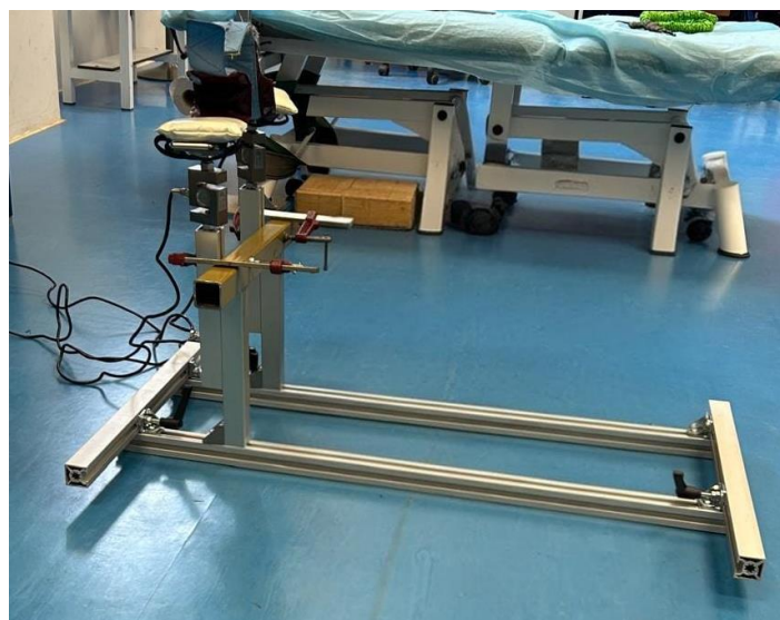
Figura 3. Estructura metálica Reverse Nordic Strength Test
