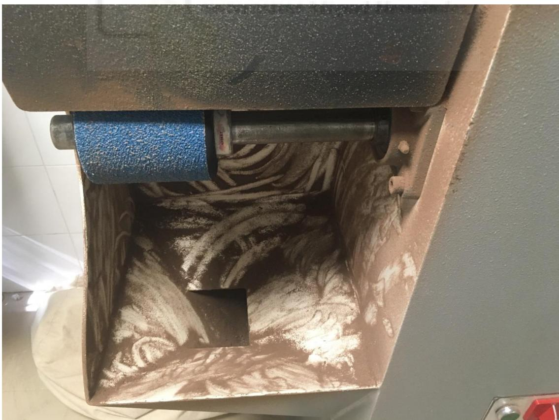
Figura 41. Pulidora después de su uso con ortesis. Elaboración propia.
