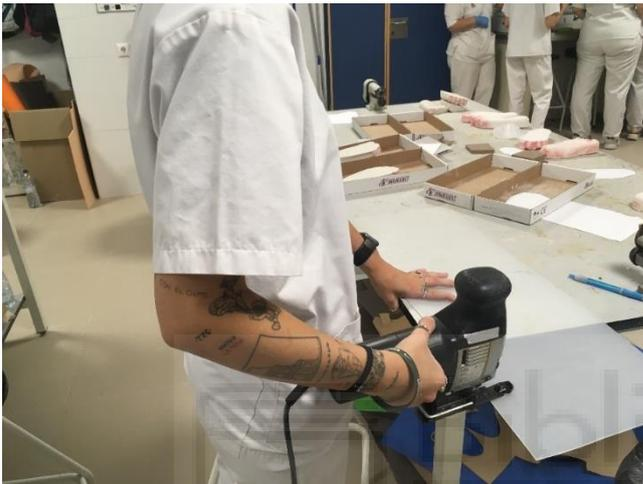
Figura 43. Trabajadora cortando polipropileno con caladora. Elaboración propia.
