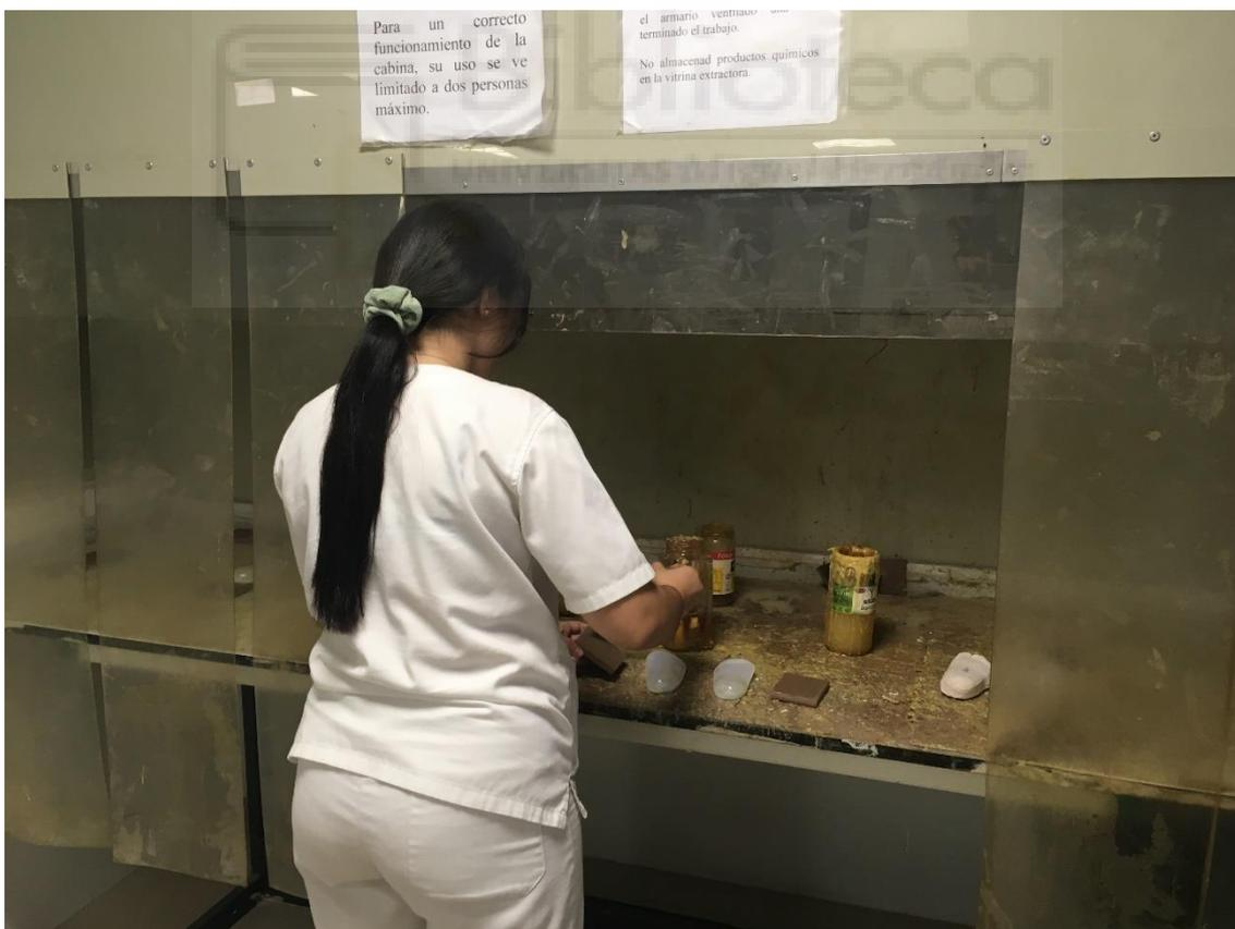
Figura 38. Trabajadora manipulando cola en campana de ventilación.
