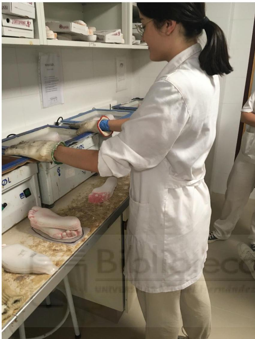
Figura 47. Trabajadora usando el vacum en el proceso de termoconformado con guantes resistentes al calor. Elaboración propia.
