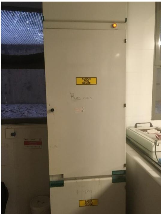
Figura 37. Armario de ventilación. Elaboración propia.
