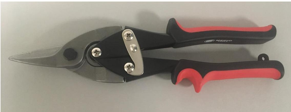
Figura 24. Tijeras especiales para termoplásticos. Elaboración propia
