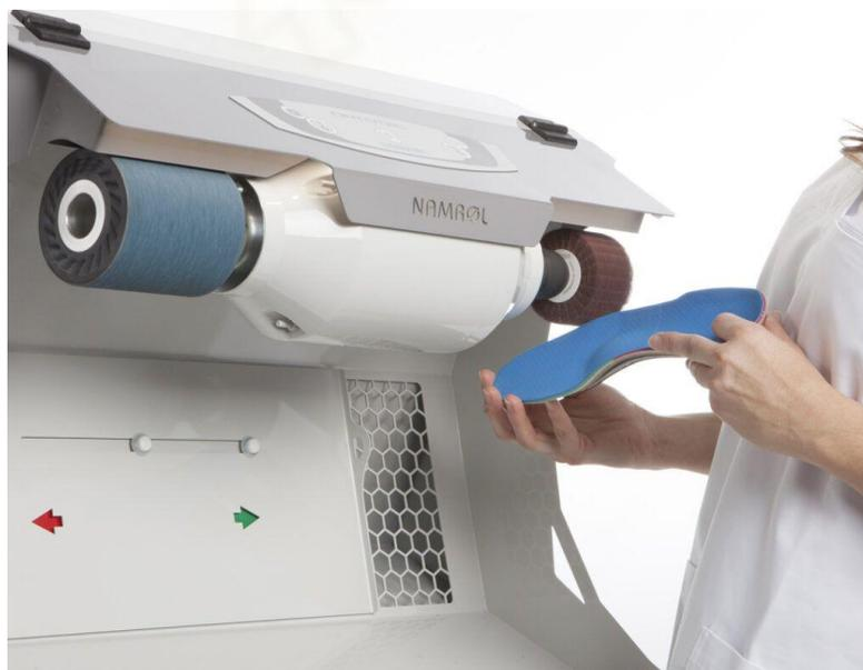
Figura 52. Sistema de aspiración en pulidora. Imagen tomada de la web de Namrol <http://www.namrol.com/>
