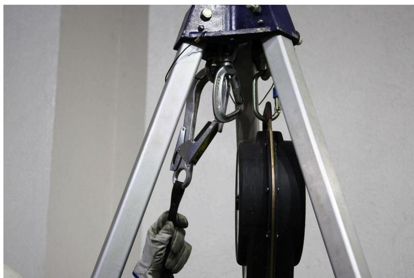
Instalamos el retráctil en los anclajes superiores del trípode. Ahora los rescatadores, pueden anclarse al 795 B superior del trípode y se sueltan de la barandilla, quedando en “sujeción”.
