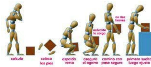
Figura 12: Optimización del manejo de cargas.
