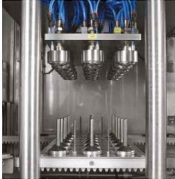
Figura 9: Abridor de biberones automático. Imagen tomada de la web de Tecniplast .
