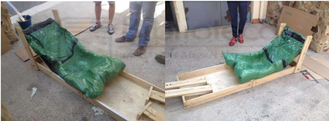
*Ilustración 22. Creación de un asiento con poliuretano bicomponente.*
