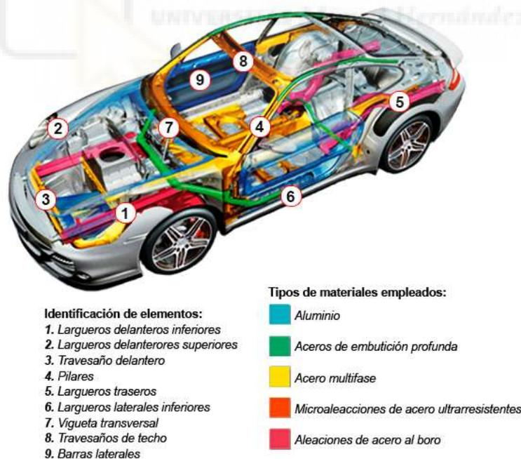
Ilustración 11. Materiales usuales de los elementos más importantes de un chasis
