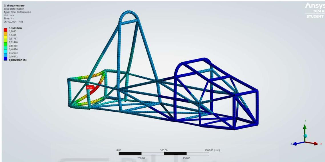
Ilustración 59. Deformación análisis impacto trasero.
