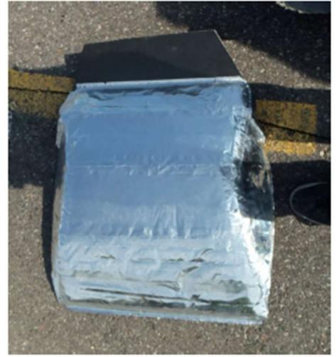
*Ilustración 23. Firewall de fibra de carbono con capa de aluminio en la parte posterior.*
