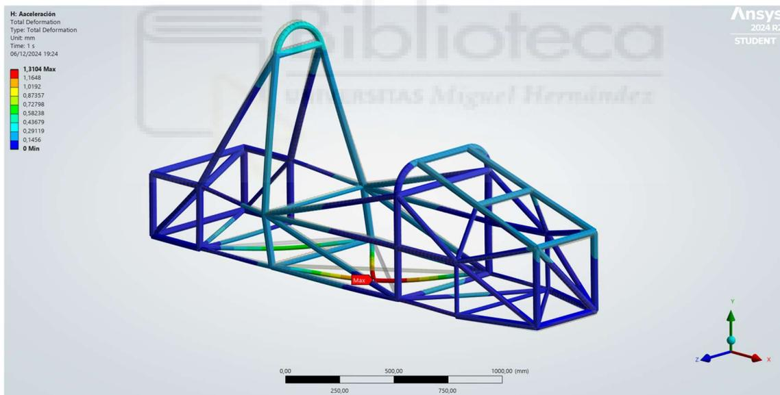
Ilustración 63. Deformación análisis de aceleración.
