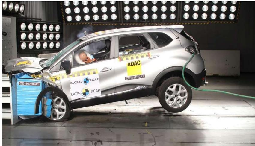
*Ilustración 12. Estudio experimental de choque frontal de un vehículo.*
