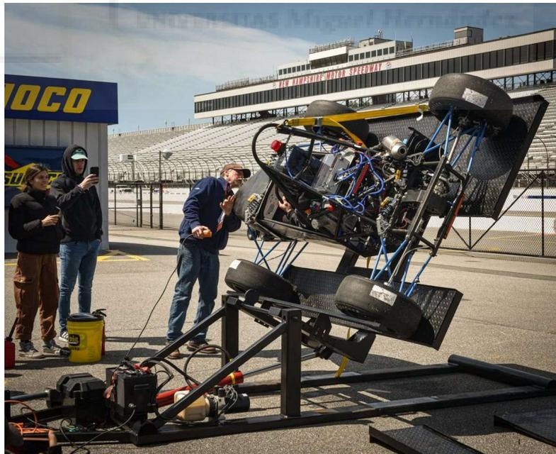
*Ilustración 4. Prueba realizada en la inspección técnica para verificar integridad del vehículo.*
