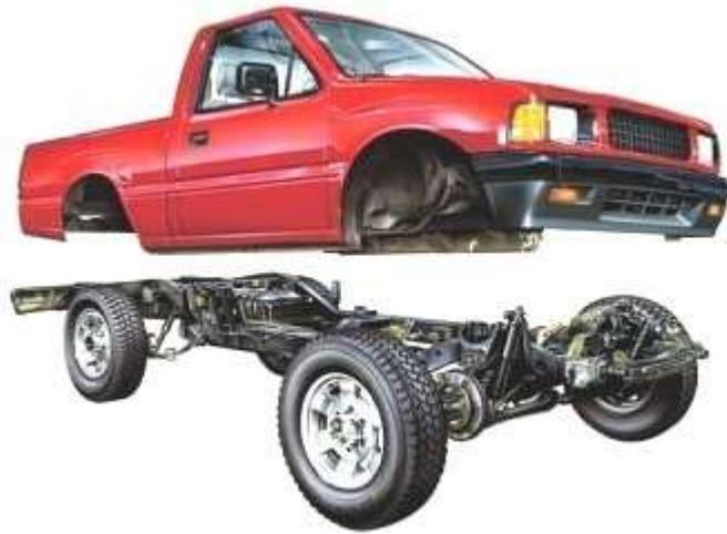
*Ilustración 13. Conjunto de carrocería y chasis independiente.*
