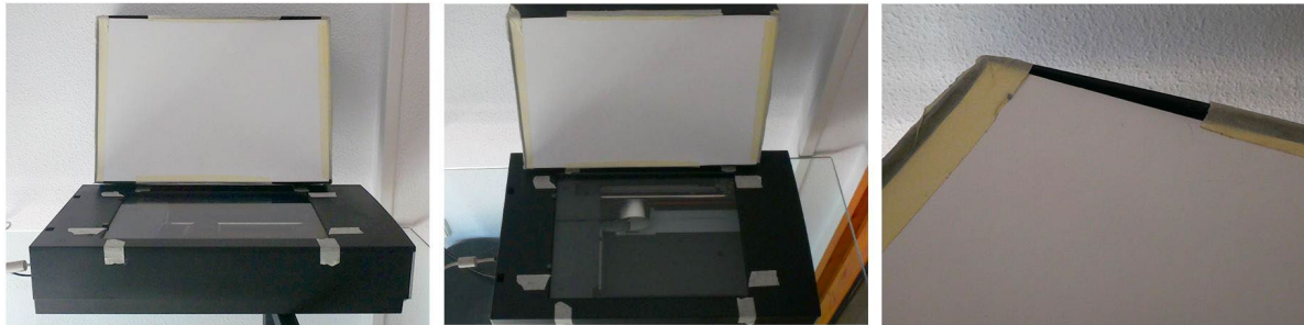
Figura 178. Escáner con la tapa diseñada para el proceso de animación.
