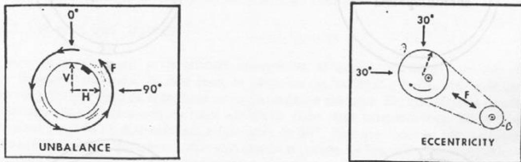
Ilustración 6. Desbalanceo/excentricidad (Imagen obtenida de la asignatura de Mantenimiento Predictivo I)
