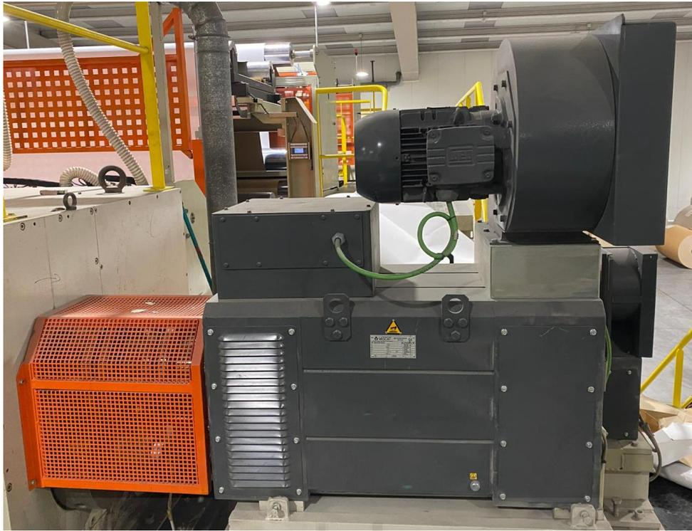
Ilustración 46. Imagen motor cuchilla
