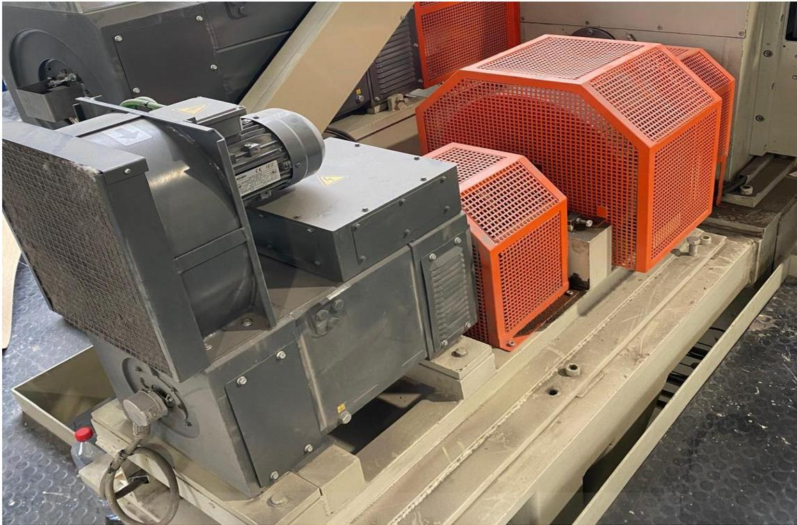
*Ilustración 39. Motor de prensa y arrastre de accionamiento*
