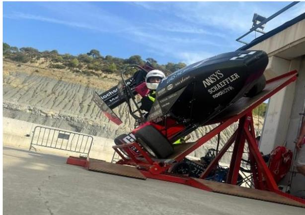
*Ilustración 1: Tilt test (Fuente: HofSpannung Motorsport)*
