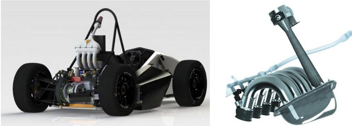
*Ilustración 18: Diferentes tipos de sistemas de admisión con toma vertical (Fuente: Dalhousie University, Sacramento's Hornet Racing Formula Team)*
