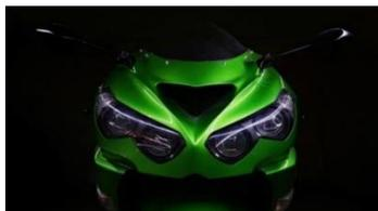
*Ilustración 19: Toma de aire Ram-air característica de Kawasaki (Fuente: zigwheels.com)*
