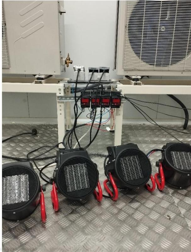
Figura 31. Disposición calefactores y PIDs
