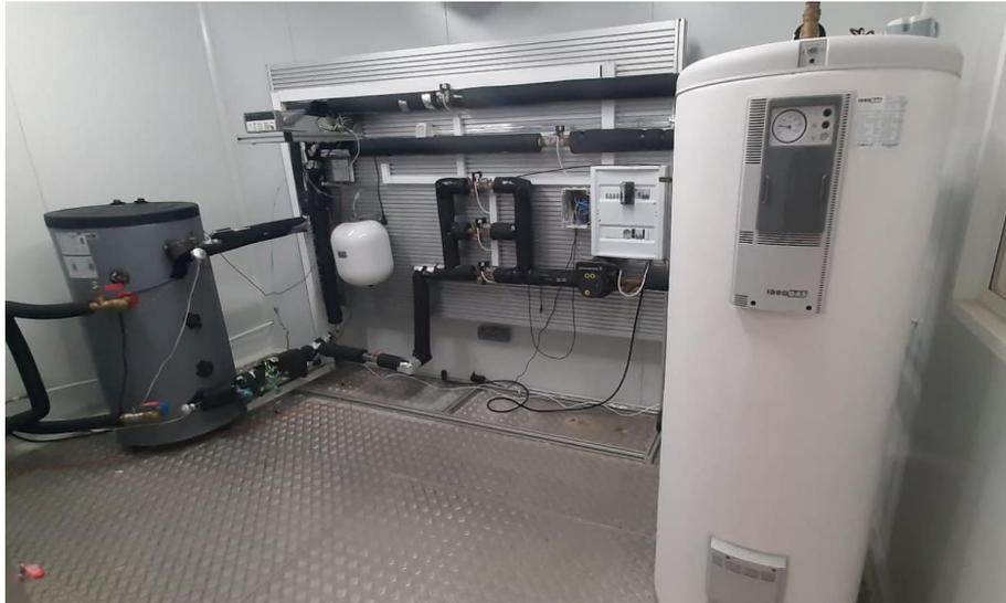
Figura 12. Equipos simulación ACS
