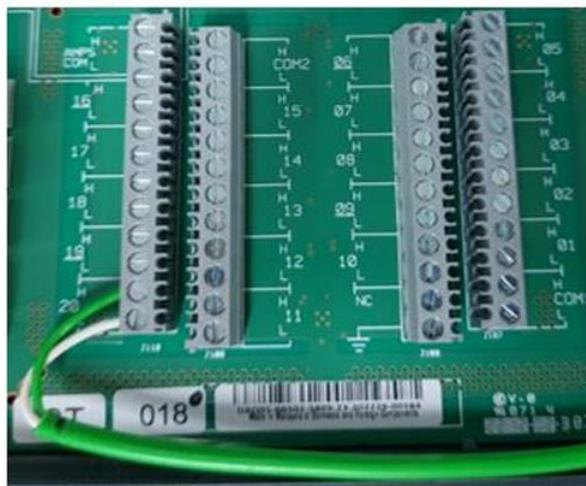
Figura 48. Conexión termopar
