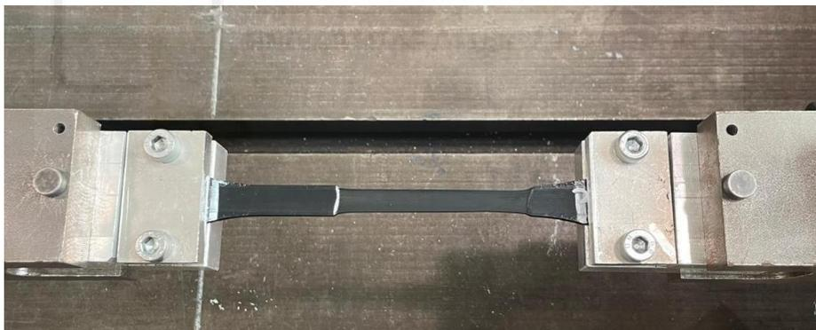
*Figura 30. Zona plástica de la probeta PETG*
