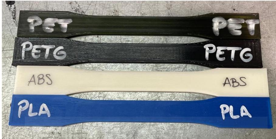
Figura 28. Probetas de los materiales a ensayar
