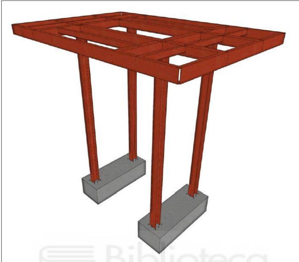
ILUSTRACIÓN 37: BANCADA TORRE REFRIGERACIÓN
