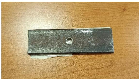
*Figura 19: Anclaje del acelerómetro con el suelo.*
