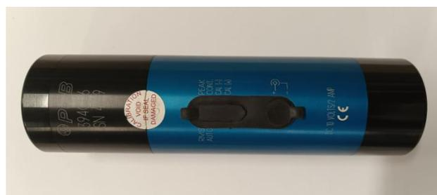
Figura 24: Calibrador del acelerómetro.
