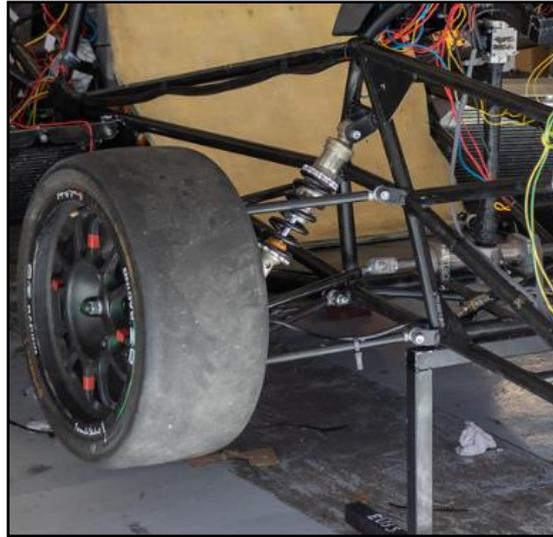
Ilustración 49. Sistema de suspensión de un monoplace de Formula Student. Fuente: extraída de la página web [formulastuent.es](http://formulastuent.es)
