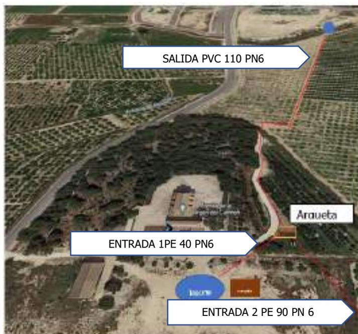
Figura 12: Croquis de tuberías que componen la arqueta de reparto
