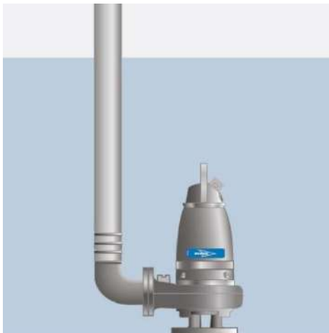
Figura 9. Equipo de bombeo Flygt sumergido.
