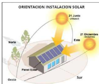
Figura 6: Orientación instalación solar
