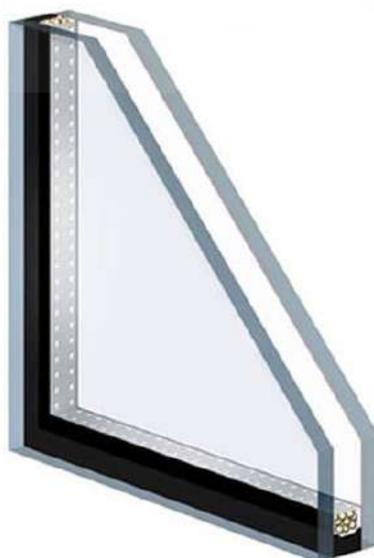
Figura 29. Imagen esquemática de una ventana con cristal doble
