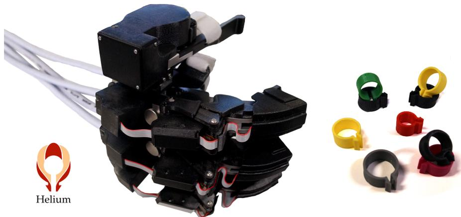
Figura 2.1: Prototipo inicial exoesqueleto de mano Helium.
