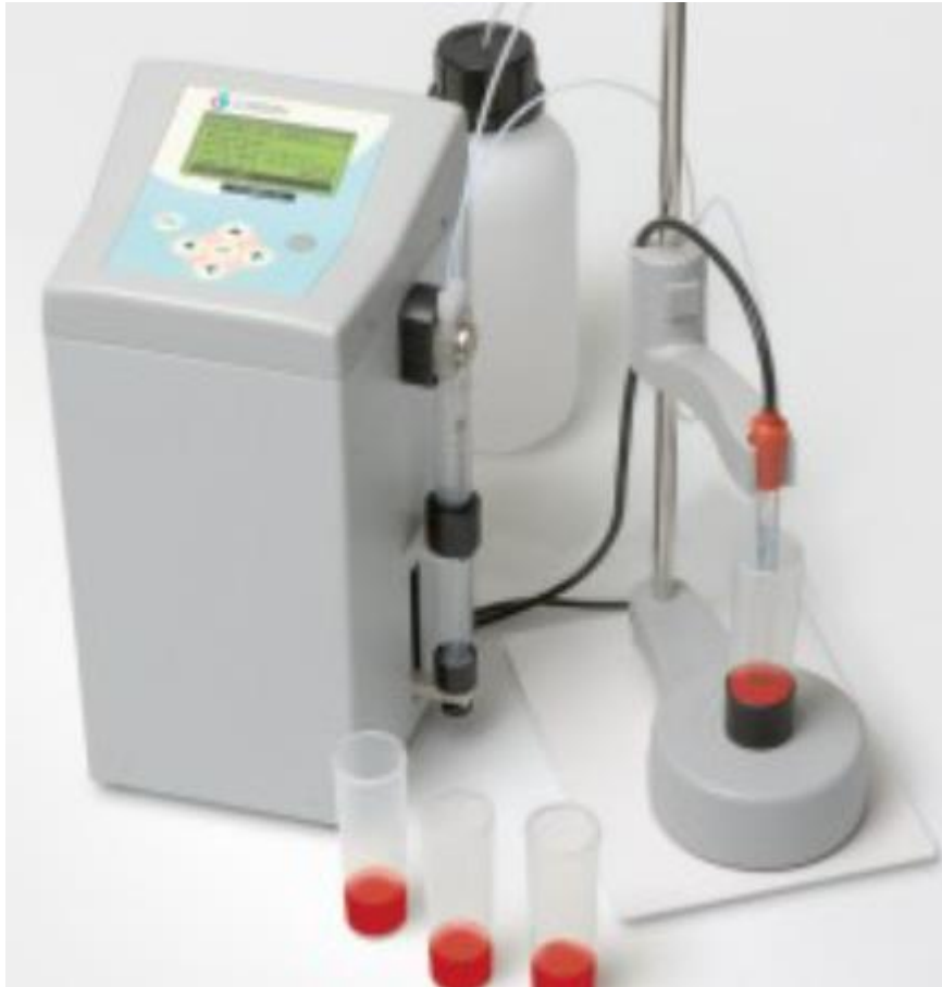
Imagen 23: pHmetro para medir acidez y pH (Página web Crison Instruments 2024).
