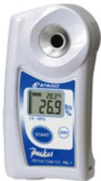
Imagen 22: Refractómetro digital ATAGO (página web ATAGO 2024).
