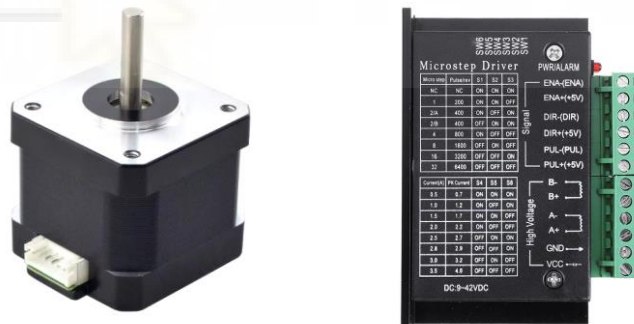
Figura 43. Conjunto motor nema 17 y driver de bucle abierto.
