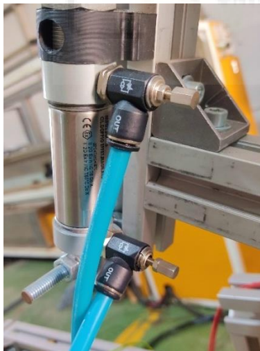
Figura 87. Reguladores de caudal en la pinza.
