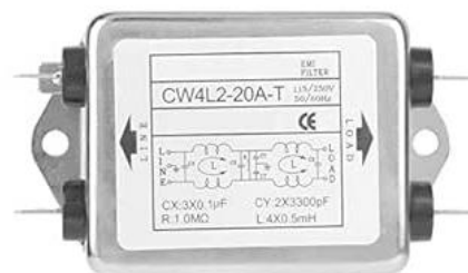
Figura 61. Filtro EMI empleado
