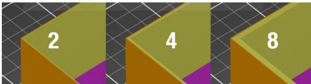
Figura 71. Distintos números de perímetros para una misma pieza. Fuente: Prusa.
