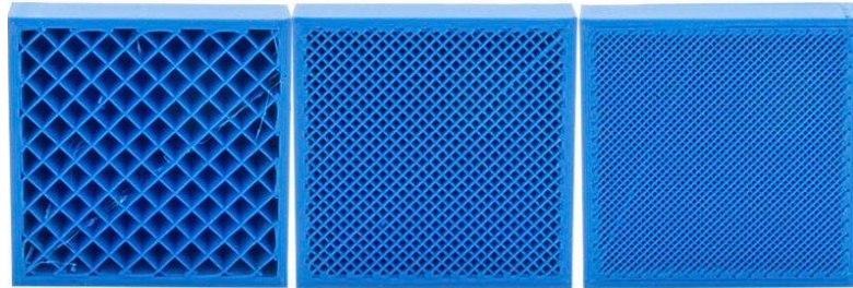
Figura 72. Distintos porcentajes de relleno para una misma pieza
