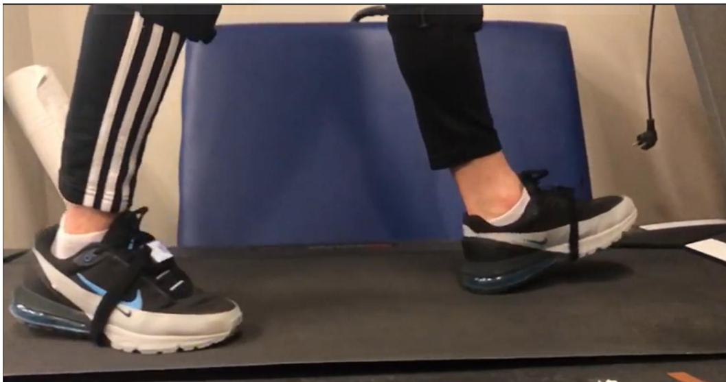
Figura 22. Sujeto R36 sobre cinta con los dispositivos IMU WitMotion para prueba detección fases de la marcha.
