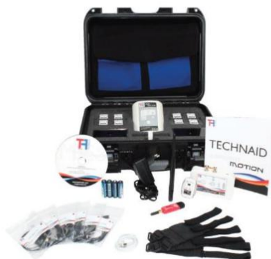
Figura 10. Equipo completo utilizado anteriormente. Tech-HUB y Tech-IMUs.
