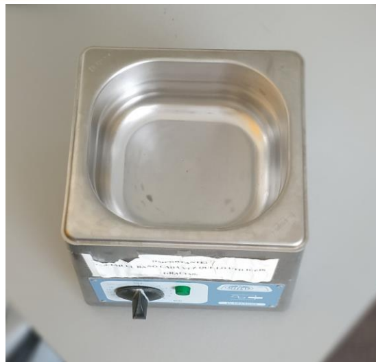
Figura 24. Imagen del sonicador utilizado en los experimentos para producir los liposomas. (Elaboración propia)
