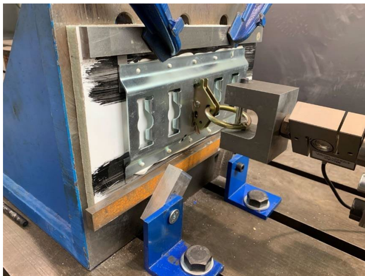
Figura 8.5. Ensayo tracción con anilla de amarre.
