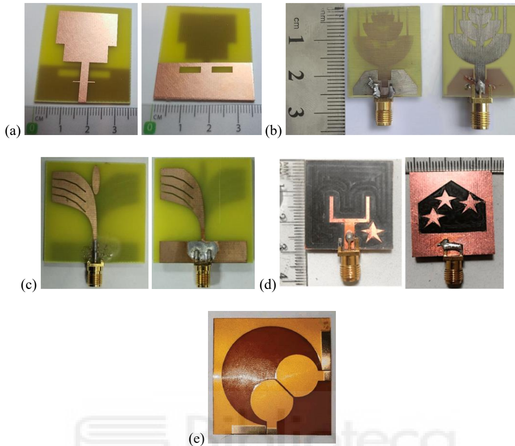
Figura 1.2. Ejemplos de antenas que se utilizan en los sistemas de imagen médica por microondas: (a) Antena monopolo [1.28]; (b) Antena fractal [1.30]; (c) Antena Vivaldi [1.31]; (d) Antena con ranuras [1.34]; (e) Antena flexible [1.36].
