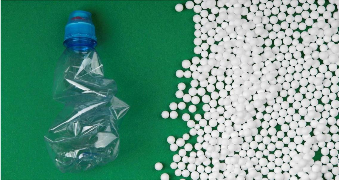
**Figura 6.** Los *pellets* o gránulos de plástico se pueden fundir y adoptar cualquier forma para fabricar un determinado producto, como una botella de plástico. *Fuente: Freepik.*
