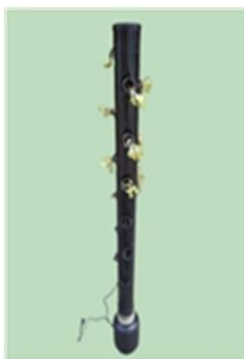
Figura 8. Prototipo físico de granja hidropónica vertical (Sistema NFT)
