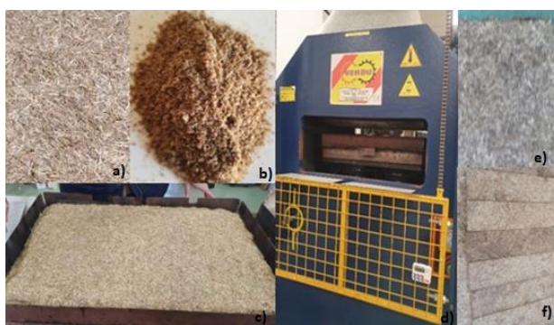
Figura 4. Secuencia del proceso de fabricación de los tableros en laboratorio: a) partículas de paja tamizadas, b) residuo piel de patata, c) manta, d) prensa hidráulica, e) tablero, f) cortes para probetas.
