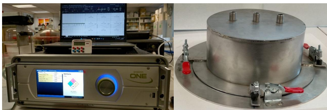
Figura 2. Gasera One Multi-gas analyzer (imagen izquierda). Cámara de acero utilizada para realizar las mediciones (imagen derecha).
