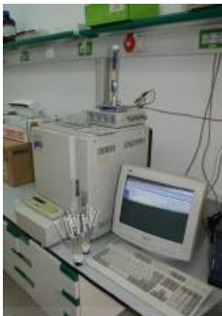
**Fotografía 2:** *Cromatógrafo de gases.*
