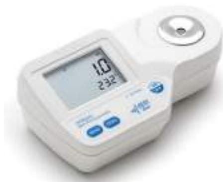
**Fotografía 4:** *Refractómetro utilizado para medir los °Brix (SST).*
