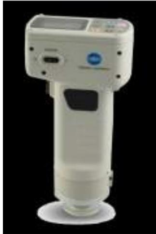
**Fotografía 3:** Colorímetro CRC 400 utilizado para medir el color.
