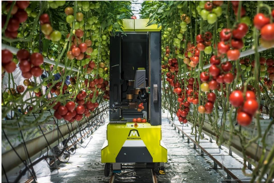
Imagen 3.2.7. Ejemplo de instalación agrícola con robot móvil de recolección en invernadero.
