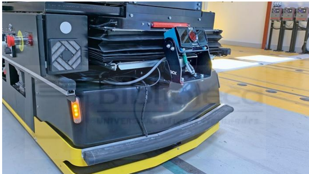
Imagen 3.1.3.e. Ejemplo real, AGV de guiado magnético de fabricante CEIT con cámara 3D SICK Visionary-T.
