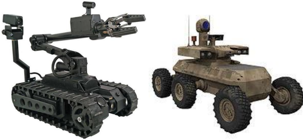
Imagen 3.2.3. Ejemplos de vehículos autónomos militares para detección y desactivación de explosivos.
