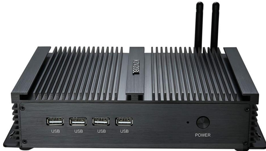
Imagen 3.1.2.iii.b. PC Industrial para controles de flota y red instalado en cuadro eléctrico de robots móviles.
