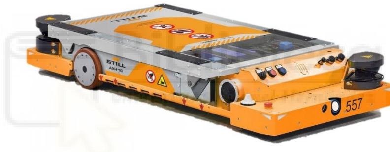
Imagen 4.3.1.2. Modelo de AMR con navegación libre planteado para Flujo 2 del cliente.
