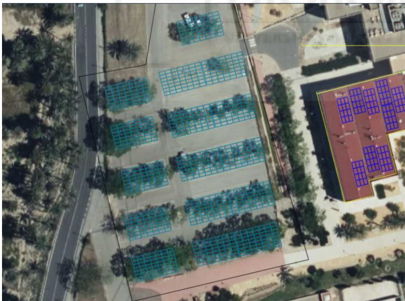
Ilustración 37: instalación mediante marquesina solar Aparcamiento Vinalopó
