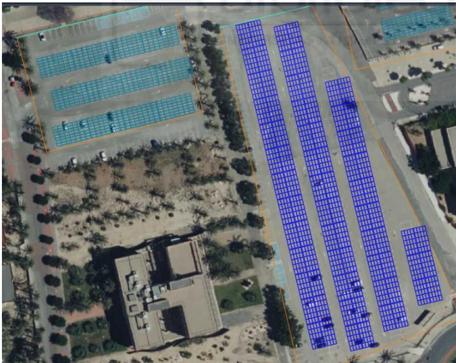
Ilustración 33: instalación mediante marquesina solar Aparcamiento Torre Blanca
