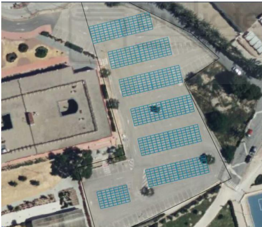
Ilustración 27: instalación mediante marquesina solar Aparcamiento Altazavares
