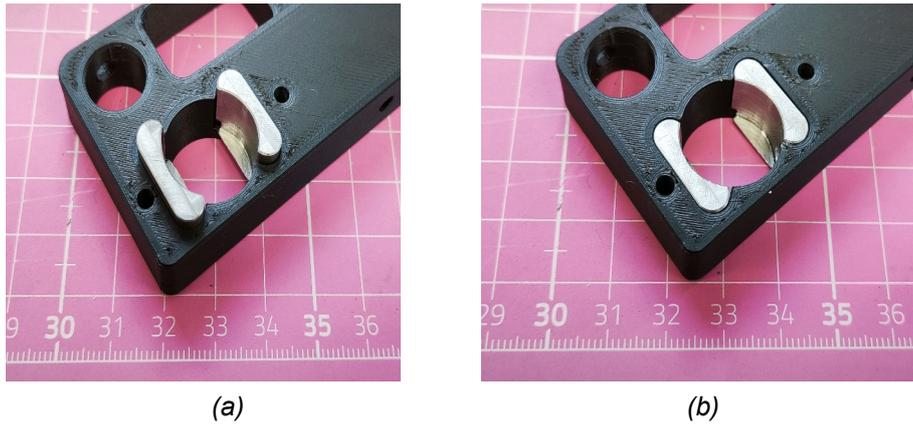
Figura 74: Proceso de ensamblaje de los colectores magnéticos (a) y ensamblaje completado (b).
