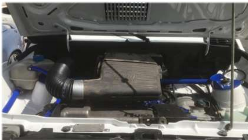
Ilustración 7: Unidad de potencia Fiat Punto instalada. Fuente: Universidad Miguel Hernández.
