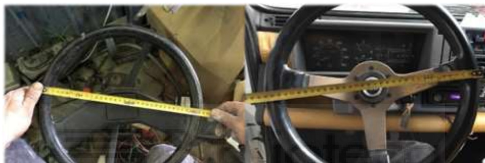
Ilustración 21: Comparativa volante original vs volante 3TR. Fuente: Universidad Miguel Hernández.
