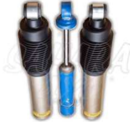
Ilustración 16: Comparativa entre amortiguador trasero original y el nuevo. Fuente: Sahara 4x4.
