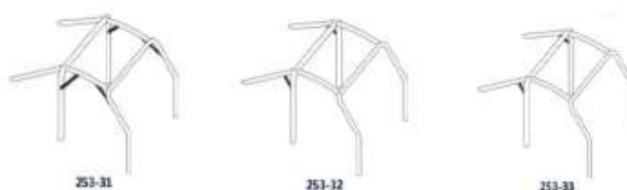
Ilustración 38: Normativa de ángulos y uniones. Fuente: FIA.
