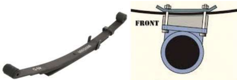
Ilustración 19: Ballesta de la suspensión reforzada. Cuñas de nylon. Fuente: Universidad Miguel Hernández.
