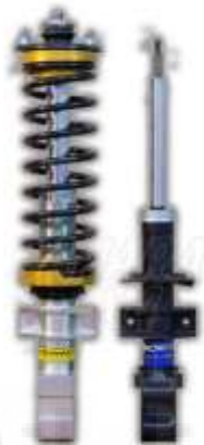
Ilustración 15: Comparativa entre amortiguador delantero original y el nuevo. Fuente: Sahara 4x4.
