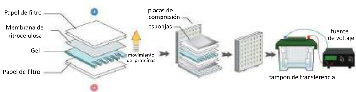
Figura 3.14. Esquema del procedimiento de una transferencia húmeda. Colocación del gel en contacto con una membrana de nitrocelulosa en la cual se transferirán las proteínas presentes en el gel. Colocación de papel de filtro a ambos lados del conjunto gel-membrana y como última capa esponjas de compresión. Todos ellos embebidos en tampón de transferencia. Este último conjunto se coloca en un cassette compresor que se introduce en la cubeta y se lo recubre con tampón de transferencia. Aplicación de 70 V durante 2 horas. Adaptado de creative-diagnostics/protocols.
