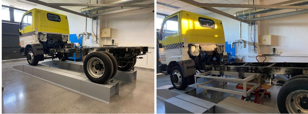
El montaje del prototipo, se completa con la integración de todos los componentes eléctricos, electrónicos y mecánicos, y con instalación de las envolventes y carcasa, como se muestra en las siguientes fotografías.
