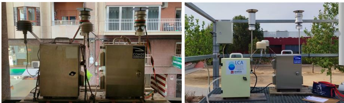
Figura 5. Captadores de bajo volumen en el centro de Elche (izquierda) y en el campus de la UMH (derecha).
