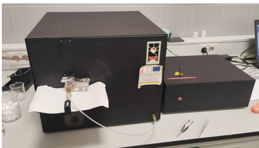
Figura 3. Equipo de análisis termo-óptico Sunset para la obtención de la concentración de carbono orgánico y elemental
