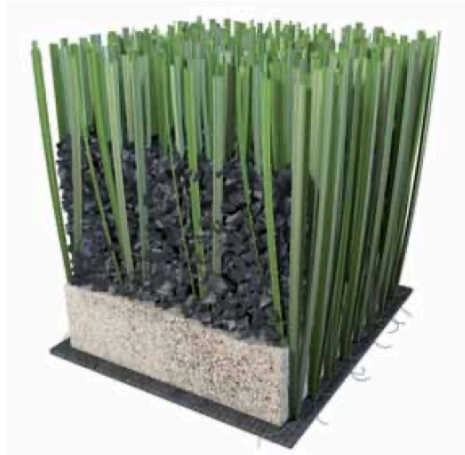
Imagen 2. Estructura del césped artificial de tercera generación. 4
