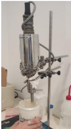
Figura 6. Branson Sonifier 250, utilizado para la rotura de las células en el proceso de purificación de KirBac F101W.
