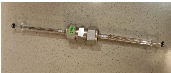
Figura 8. Imagen del extrusor (Liposofast), empleado en la obtención de los LUVs con tampón 10 mM HEPES, 150 mM KCl a pH 7.
